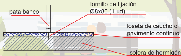
ESQUEMA DE CIMENTACIÓN EN HORMIGÓN
