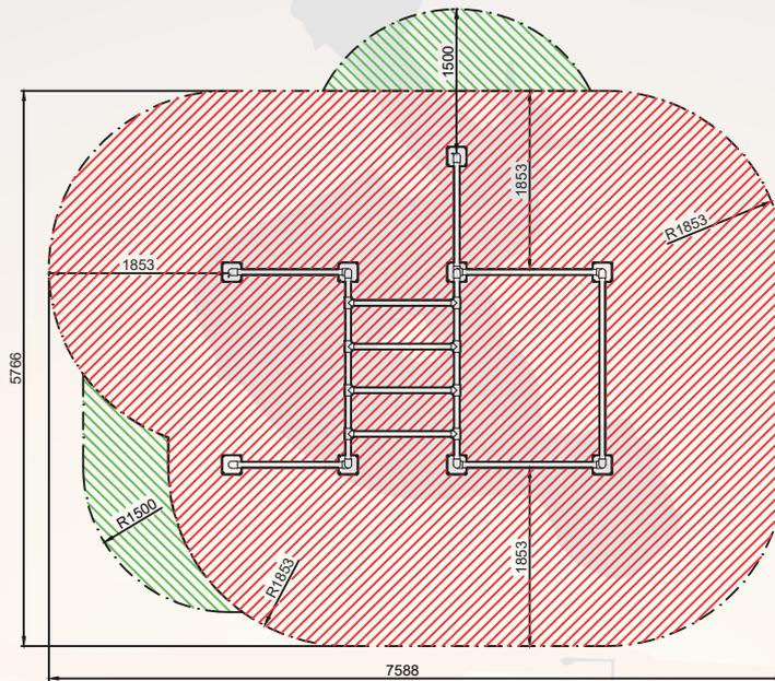
ÁREA TOTAL: 40,90 m<sup>2</sup>    Altura caída 2,03 m: 37,55 m<sup>2</sup>    Altura caída 0,70 m: 3,35 m<sup>2</sup>
