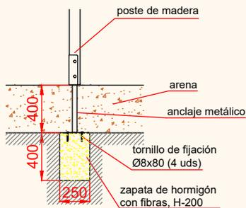
ESQUEMA DE CIMENTACIÓN EN HORMIGÓN
