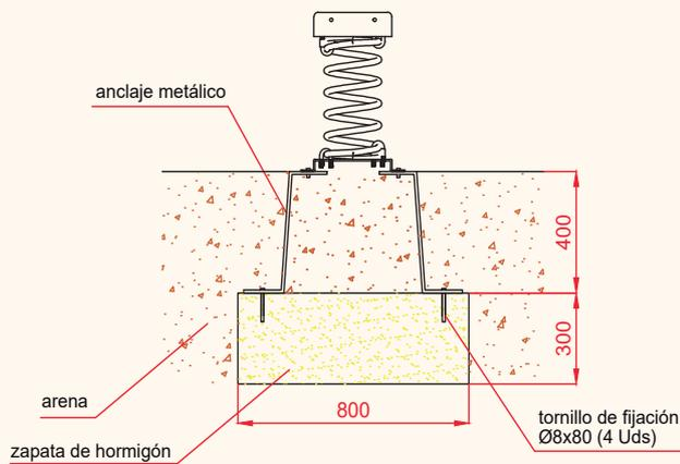
ESQUEMA DE CIMENTACIÓN EN HORMIGÓN
