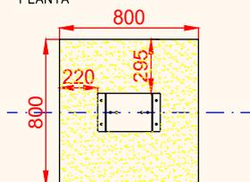
ESQUEMA DE CIMENTACIÓN EN HORMIGÓN
