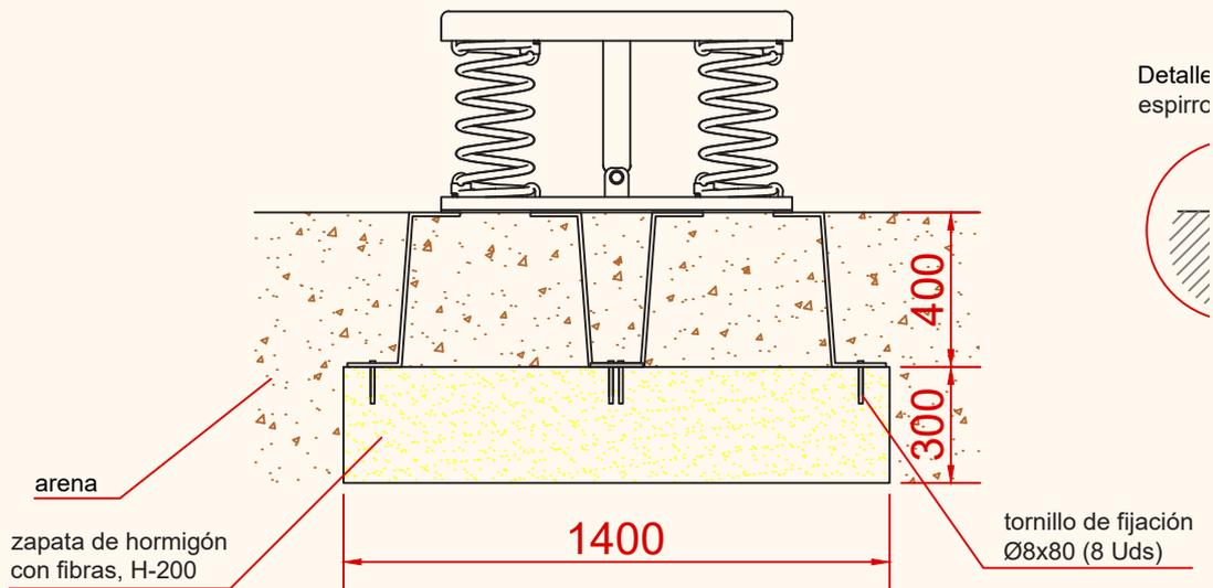
ESQUEMA DE CIMENTACIÓN EN HORMIGÓN
