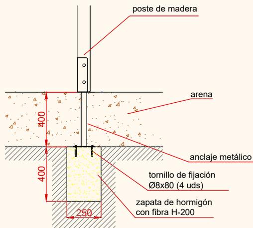
ESQUEMA DE CIMENTACIÓN EN HORMIGÓN
