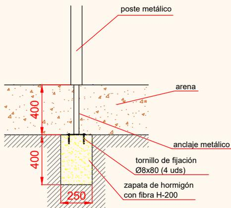
ESQUEMA DE CIMENTACIÓN EN HORMIGÓN
