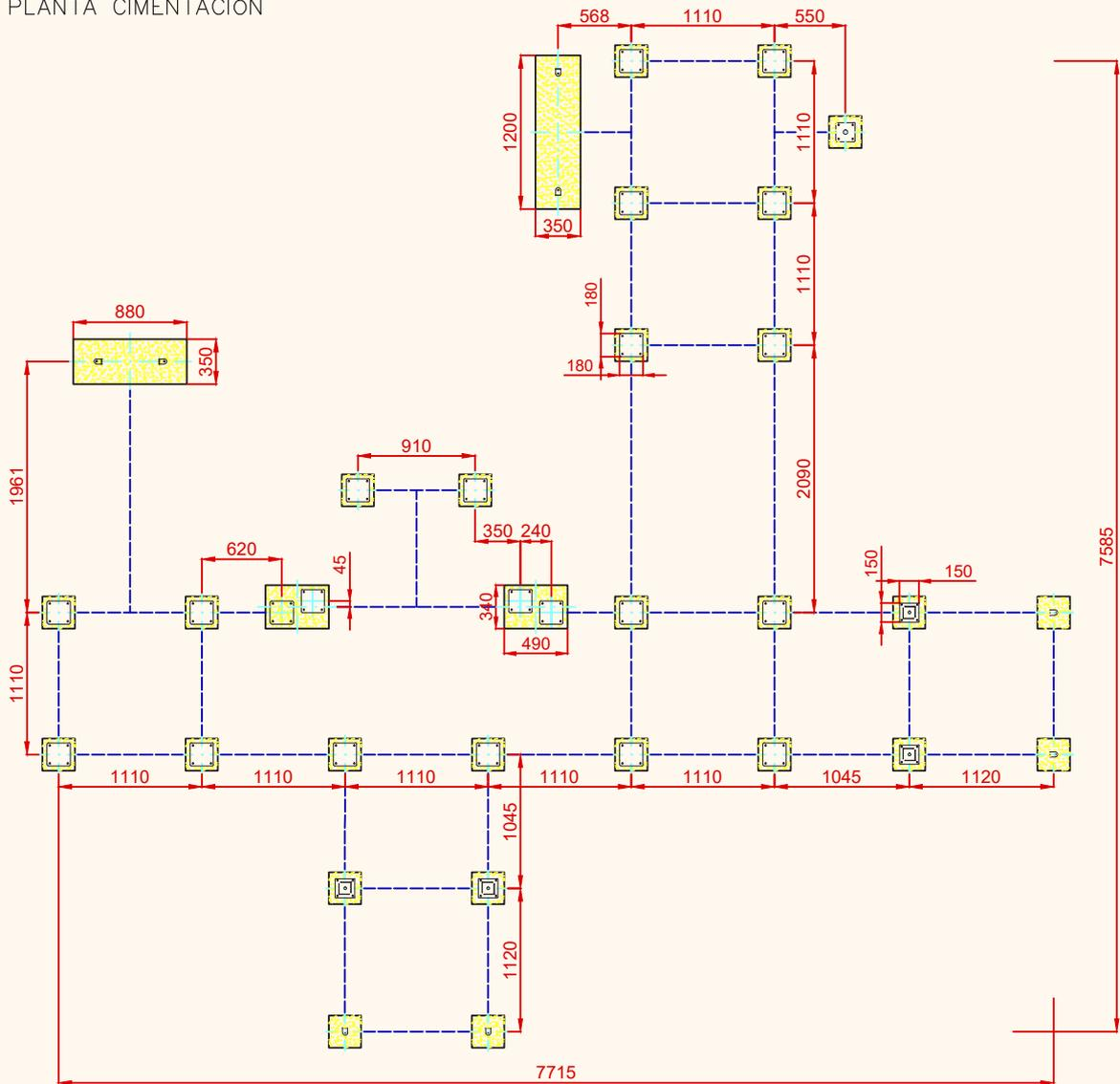
ESQUEMA DE CIMENTACIÓN EN HORMIGÓN
