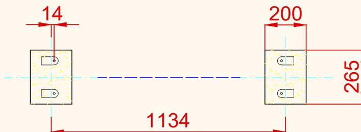
ESQUEMA DE CIMENTACIÓN EN HORMIGÓN
