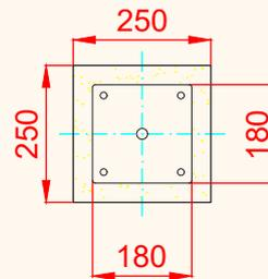
ESQUEMA DE CIMENTACIÓN EN HORMIGÓN
