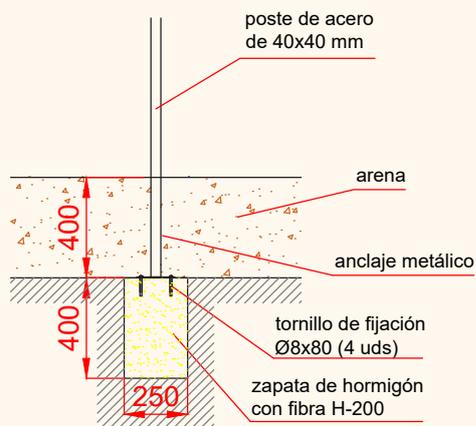
ESQUEMA DE CIMENTACIÓN EN HORMIGÓN
