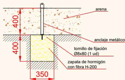
ESQUEMA DE CIMENTACIÓN EN HORMIGÓN
