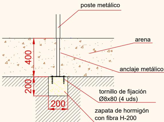
ESQUEMA DE CIMENTACIÓN EN HORMIGÓN
