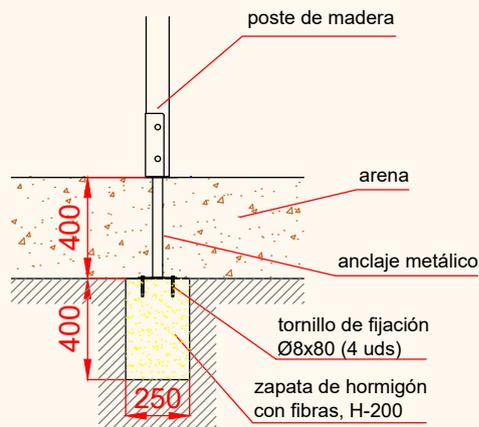
ESQUEMA DE CIMENTACIÓN EN HORMIGÓN
