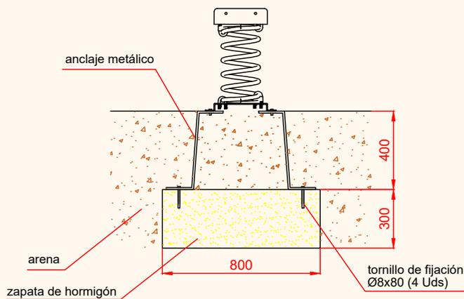
ESQUEMA DE CIMENTACIÓN EN HORMIGÓN
