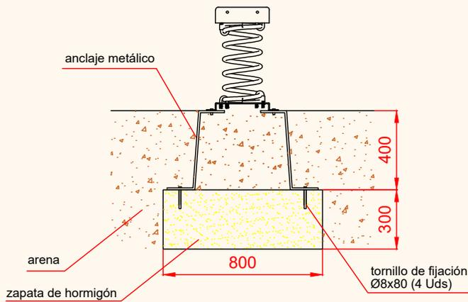
ESQUEMA DE CIMENTACIÓN EN HORMIGÓN
