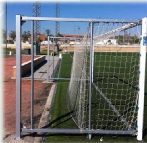
El marco de la portería lo forman un larguero y dos postes hechos con perfiles de aluminio de diámetro 90mm, que garantizan la resistencia de la estructura debido al nervado interior que tienen al ser hechos por extrusión.
